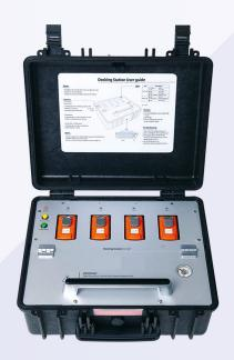
Bump-Test Systeme an tragbaren Geräten werden auf dem Markt immer beliebter. Die beste Methode, um sicherzustellen, dass der Sensor wie vorgesehen funktioniert und nicht gestört wird, bleibt die Gewährleistung, dass die Sensoren auf eine bekannte Gaskonzentration reagieren.
