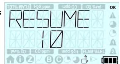
Appuyer simplement sur le bouton de commande pour conserver ces valeurs, ou ne pas cliquer sur le bouton de commande et permettre l'expiration du compte à rebours.
