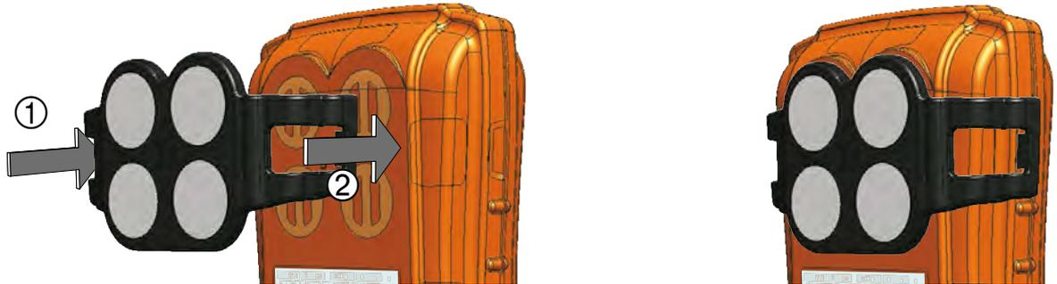
La plaque de filtres peut être utilisée dans une zone dangereuse.
